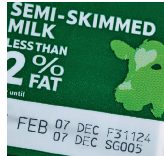
期限情報のマーキング 乳製品の厚紙製の箱上にあるフィルムにレーザー感応コーティングを施して色変化でマーキング
