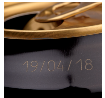
金属上での塗料の除去によるロゴ形成
